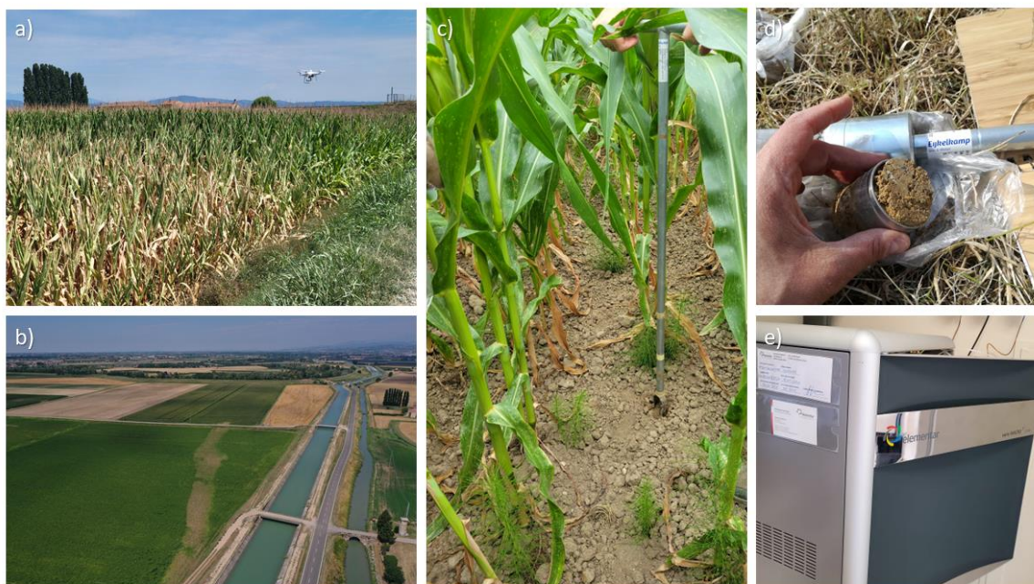
Figura 2: esempio dei rilievi effettuati a scala di azienda: concomitante al volo con drone (a,b) è stato effettuato il prelievo dei campioni di suolo con trivella (c) per l'analisi chimico-fisica di laboratorio (d,e). In Figura b) è riportata la visione dall'alto catturata dal drone durante il rilievo, dove emerge una fascia dell'appezzamento in chiara situazione di stress vegetativo.
